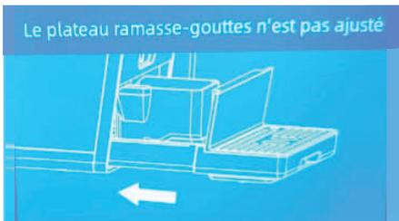
Installer le bac d'égouttage dans son siège à la base de l'appareil.
