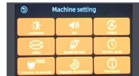
Lors de la première utilisation de l'appareil ou après la réinitialisation des paramètres d'usine, la langue de l'appareil, l'unité de mesure et la dureté de l'eau doivent être configurées.
