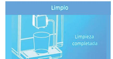
Repetir el programa de mantenimiento sin detergente para eliminar cualquier residuo del producto utilizado.
