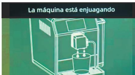
El aparato comienza la fase de enjuague de los circuitos internos y descarga el agua de desecho por la boquilla de erogación del café. En la pantalla del aparato se muestra la página correspondiente.
