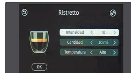
Pulsar las flechas (< >) o girar el selector giratorio para ajustar los parámetros de la bebida deseada. Confirmar para volver a la pantalla inicial de bebidas. Ahora la bebida seleccionada tendrá los parámetros configurados.
