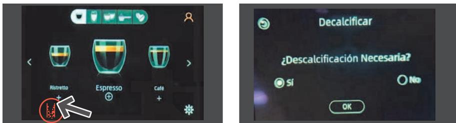
Alternativamente, se puede iniciar manualmente el proceso de descalcificación del aparato. La duración del proceso de descalcificación es de 45 minutos.
